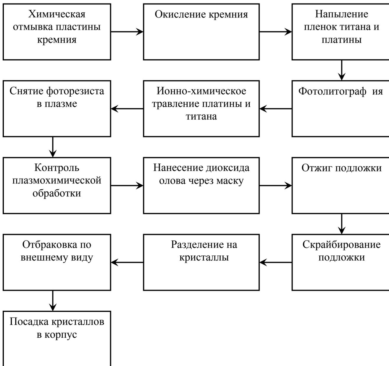
Рис. 2.2. Схема технологического процесса изготовления датчика[73]
