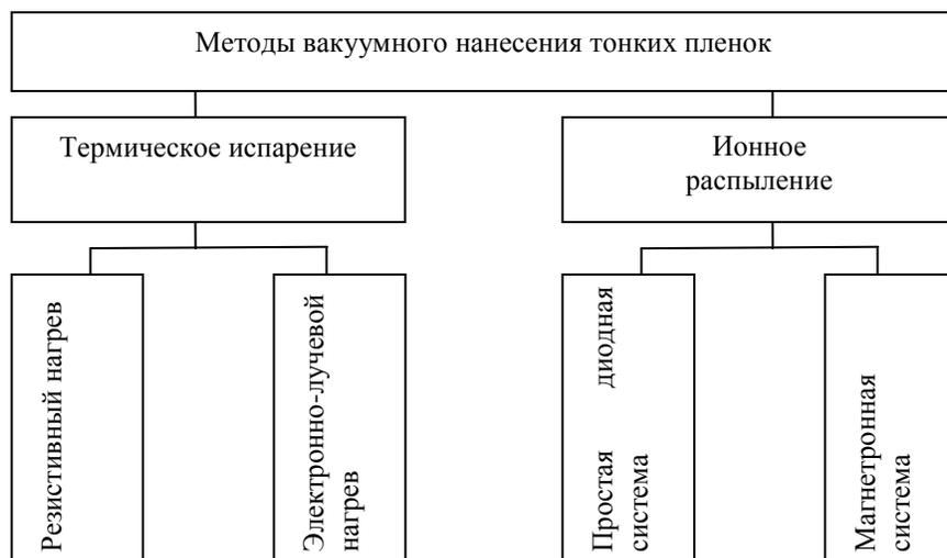
Рис. 1.3. Классификация основных методов вакуумного нанесения тонких пленок [29]
